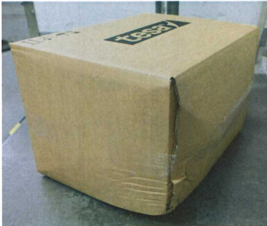
Bild 10: Muster nach Fall auf die Ecke (Bruttomasse 20,9 kg)
