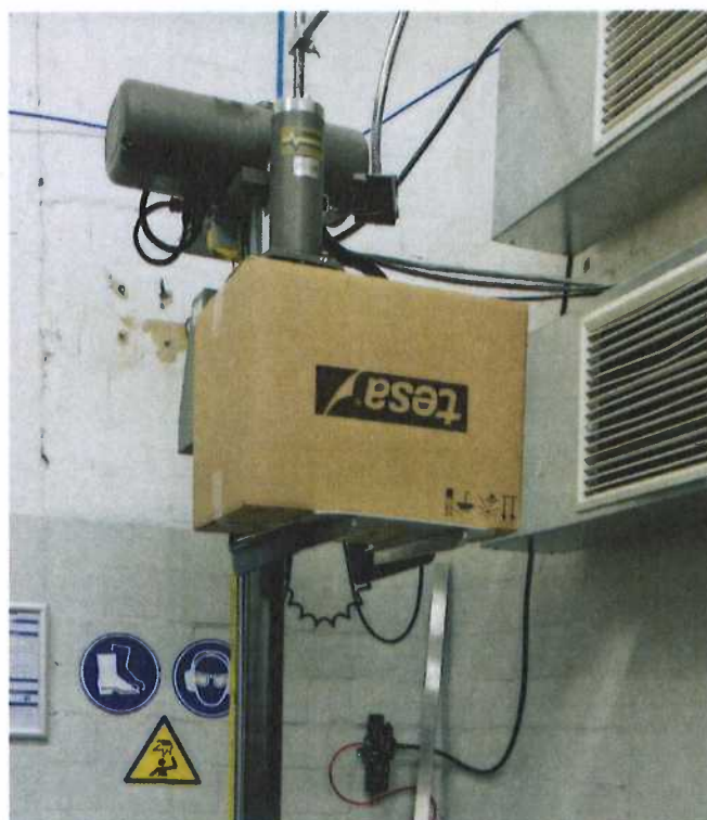
Bild 5: Fall auf die Deckelseite
